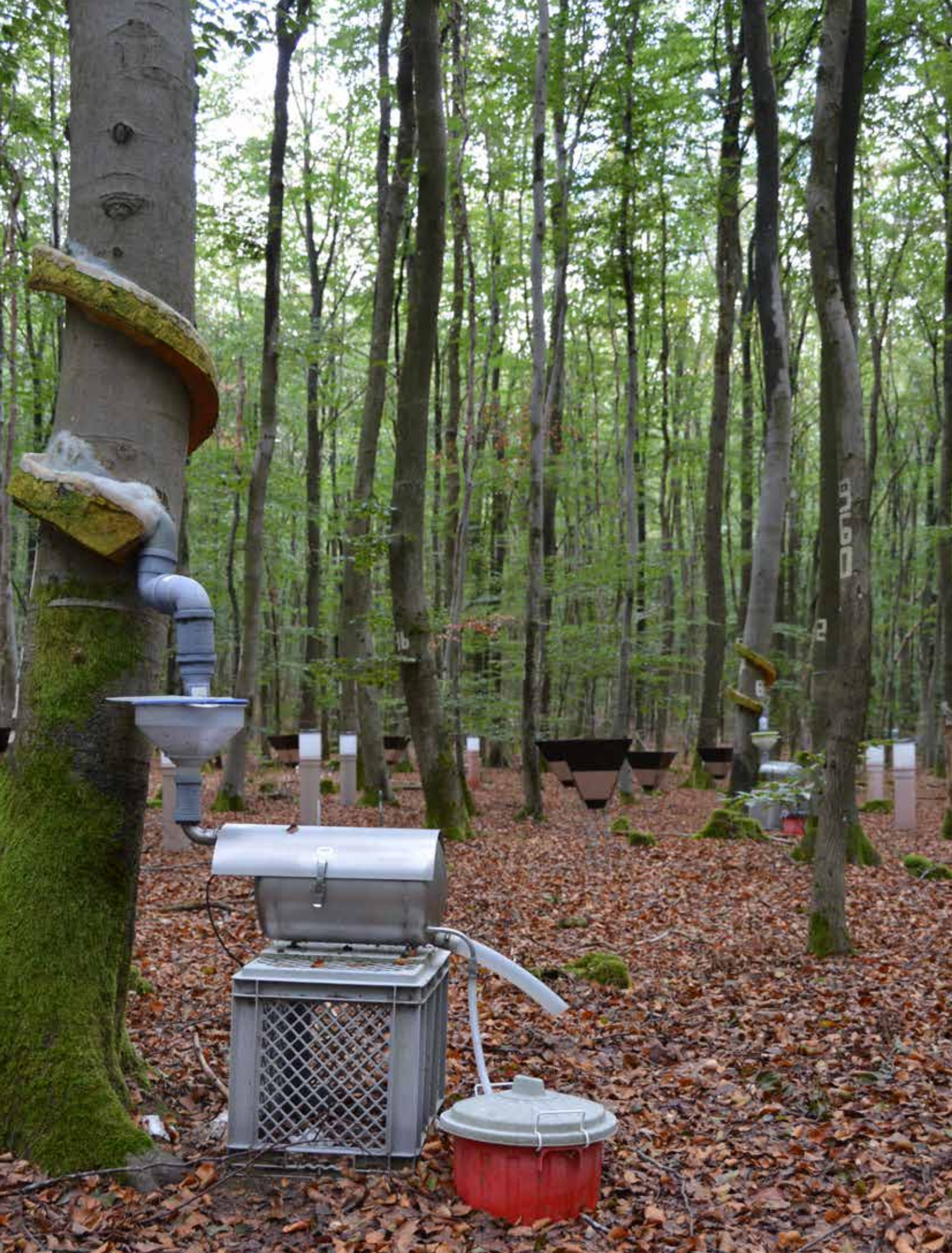
Blick in die Umweltkontrollstation Buche, Merzalben. Im Vordergrund Stammabflussmessung, im Hintergrund Depositions- und Streufallsammler
